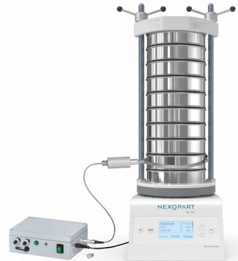
Système d'ultrasons avec variation de fréquence AGS, avec bague de serrage et convertisseur sur la tamiseuse de laboratoire EML 200 Premium
