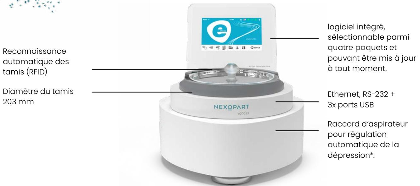
\* Veuillez noter qu'un dispositif d'aspiration doit impérativement être commandé avec la tamiseuse à jet d'air.
